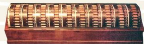
Снаряд для сложения и вычитания Слонимского
